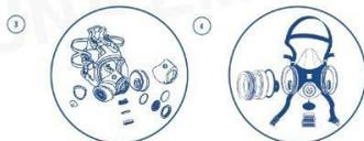
**2- Desarme.** Desarma el equipo separando las partes lavables (cuerpo de silicona y soporte) de las no lavables (banda elástica y filtros).
